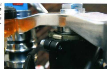
Vlevo nahoře je dobře patrné nastavení výšky uložení tlumiče excentry. Vlevo dole první rám FGR svařený z CrMo trubek. Vpravo dole detail seřizování úhlu hlavy rámu po čtvrt stupni.
