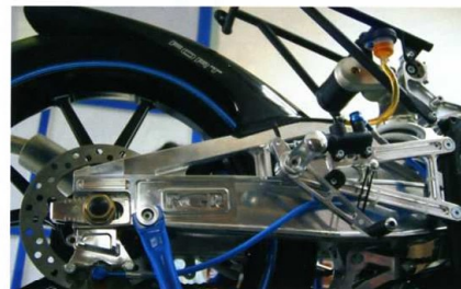
Vlevo nahoře je dobře patrné nastavení výšky uložení tlumiče excentry. Vlevo dole první rám FGR svařený z CrMo trubek. Vpravo dole detail seřizování úhlu hlavy rámu po čtvrt stupni.
